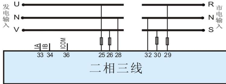
图10 二相三线连接时接线图
