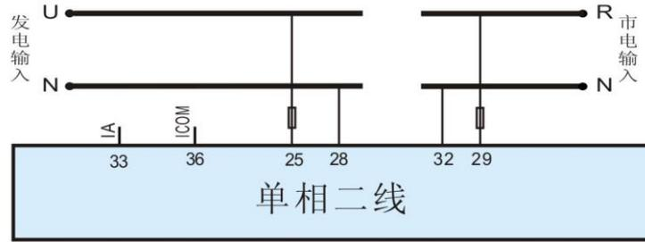
图9 单相两线接线图
