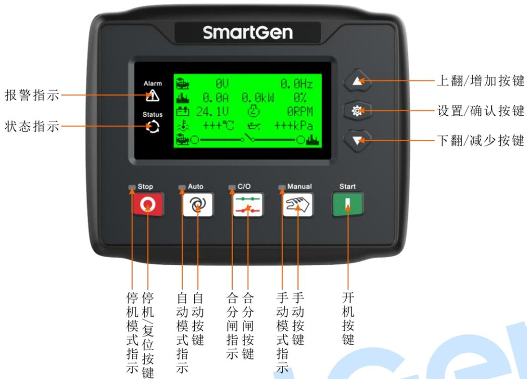
图1 HGM4010N/HGM4010NC/HGM4010CAN 前面板指示
